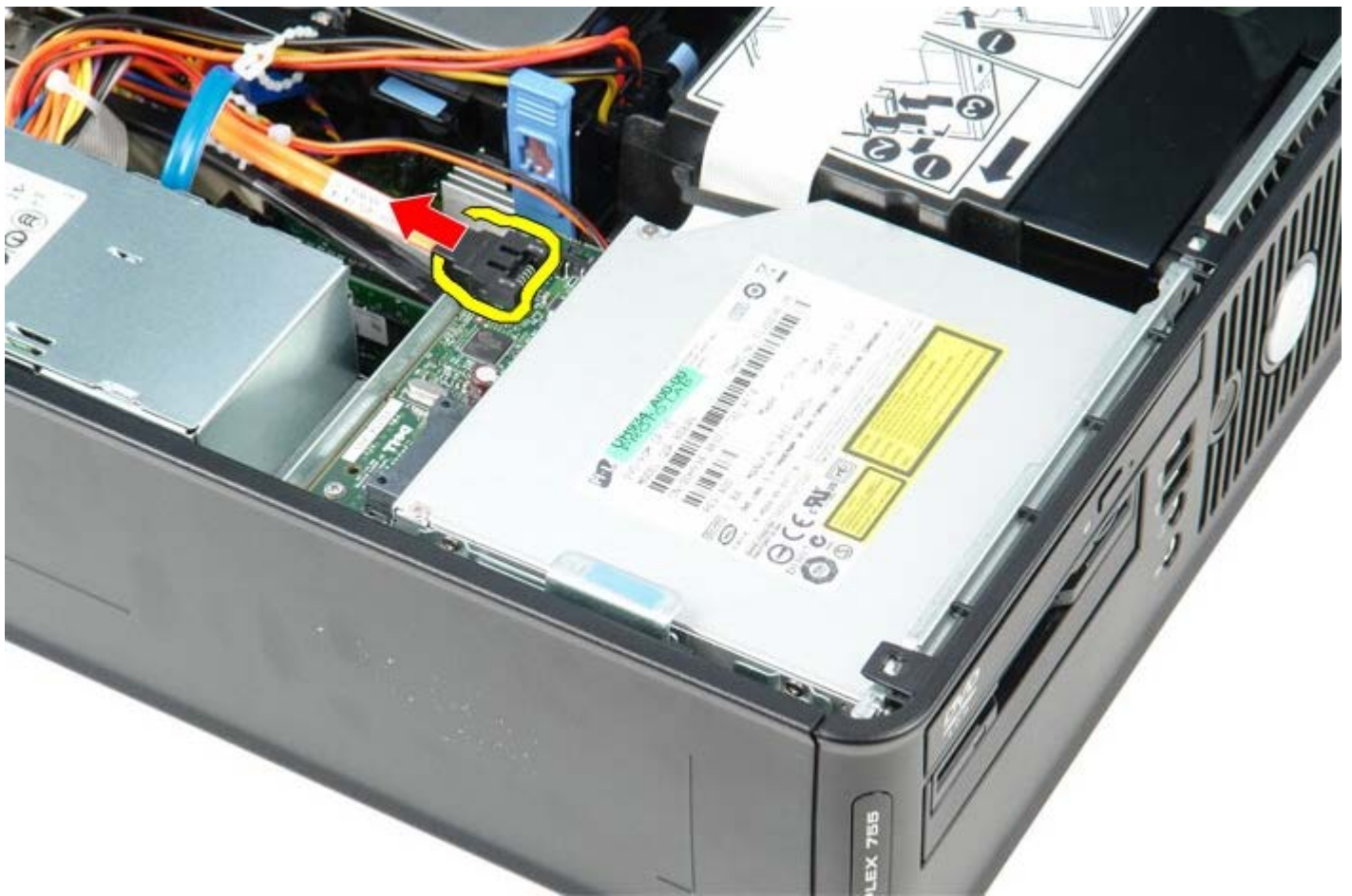
1 11 ドライブリリースラッチを引き上げ、光学ドライブをコンピュータの背面方向にスライドさせます。
