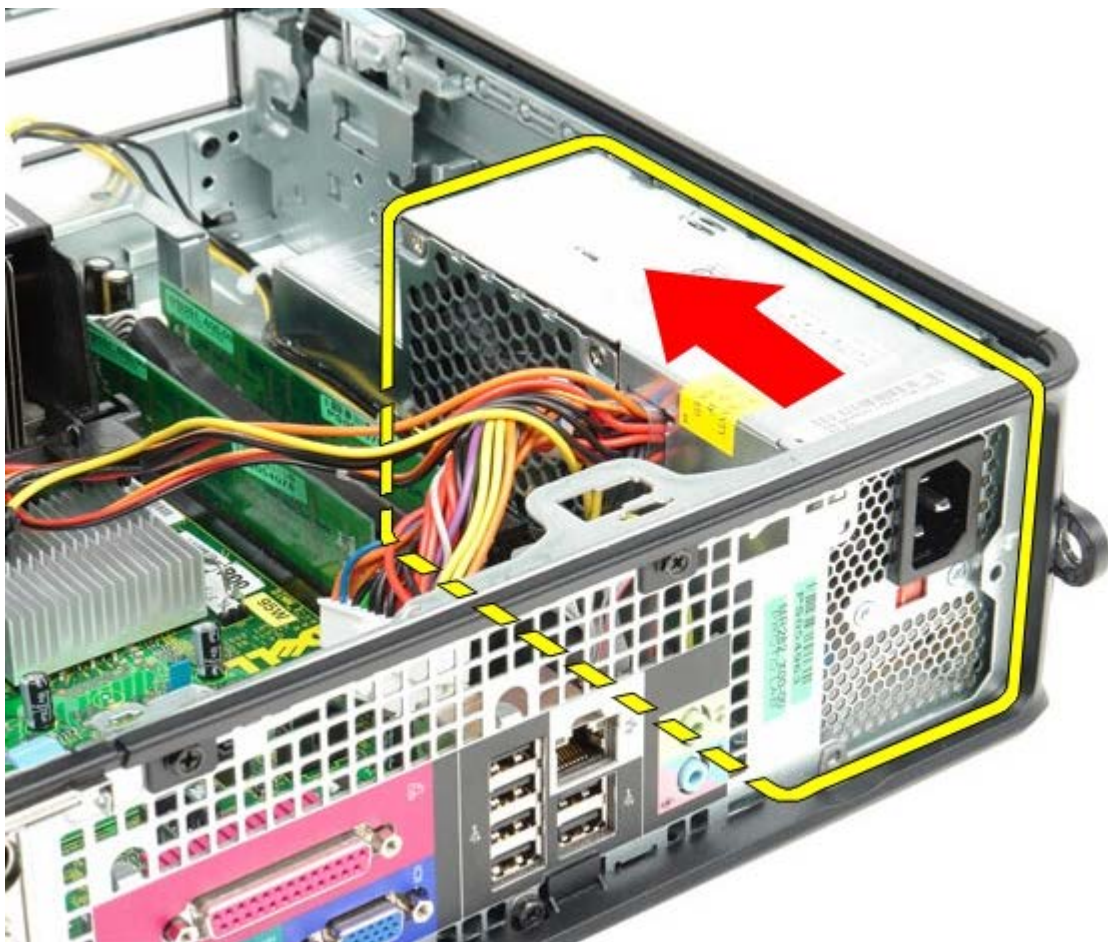
1 11 電源ユニットを持ち上げながら、コンピュータから取り出します。
