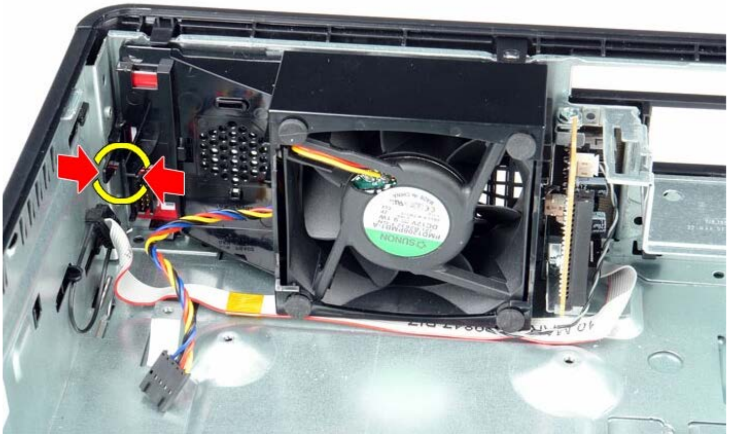
1 11 ファンを前方に倒し、コンピューターシャーシから取り外します。
