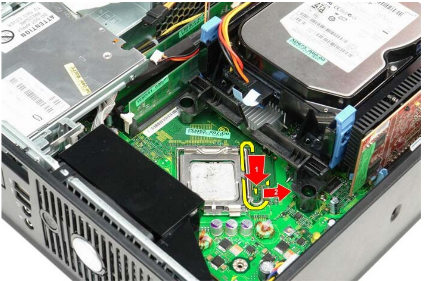
1 11 プロセッサカバーを持ち上げます。
