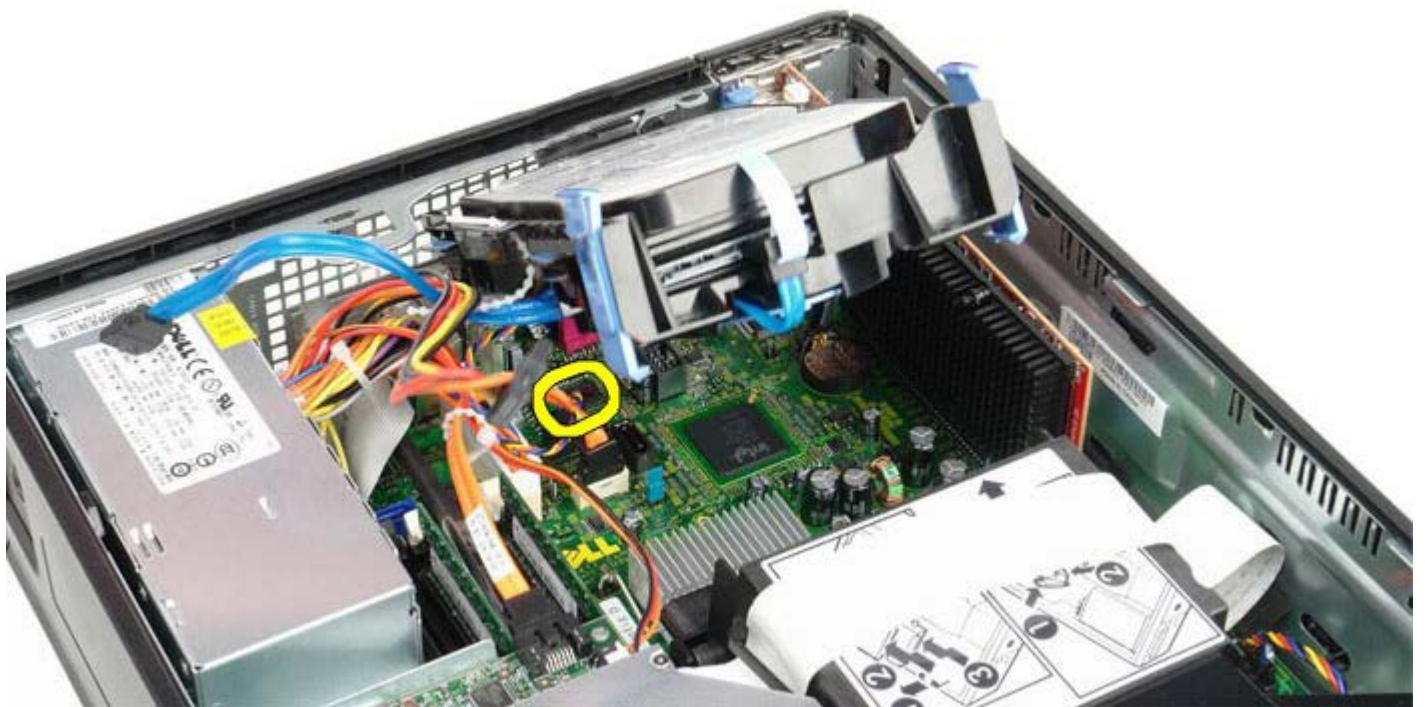
1 11 ハードドライブシャーシをコンピューターから取り外します。
